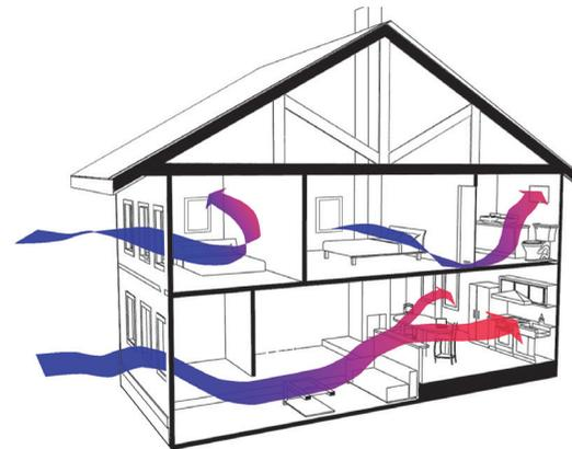
**Figura 9.1:** Esquema de ventilación de una vivienda
