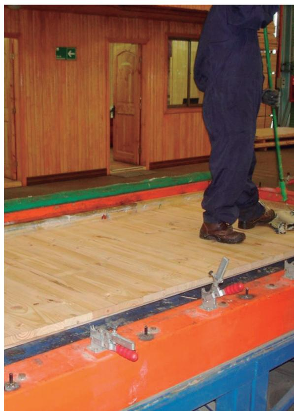
Figura 10.22: Prefabricación de los paneles de CLT
