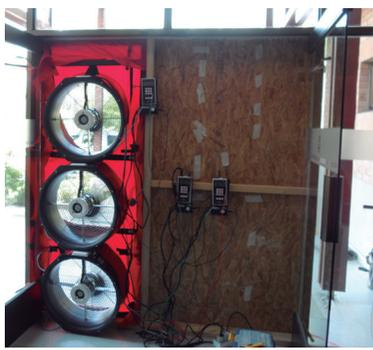
**Figura 2.3:** Equipo Model 3 Three Fan System Minneapolis instalado.
