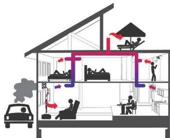
**Figura 9.11:** Incorrecta localización de admisión y extracción
