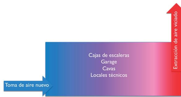
**Figura 9.9:** Esquema de circulación flujos de aire edificios de servicios
