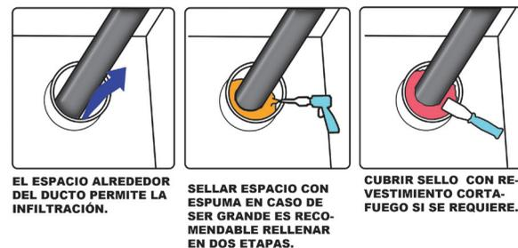
Figura 8.17: Proceso de sello en ductos
