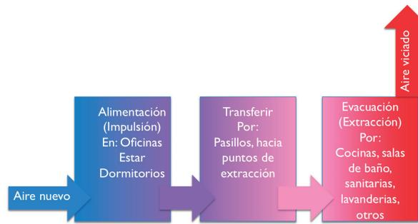
**Figura 9.8:** Esquema de circulación flujos de aire viviendas
