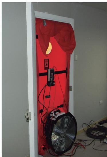
**Figura 2.2:** Equipo Standard Model 3 Minneapolis en funcionamiento.
