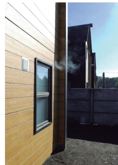
Figura 10.19: Visualización de flujos de aire con humo
