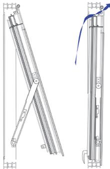
**Figura 4.14:** Aberturas generadas por los diferenciales de presión asociados a los mecanismos de cierre y descadres en ventanas.
